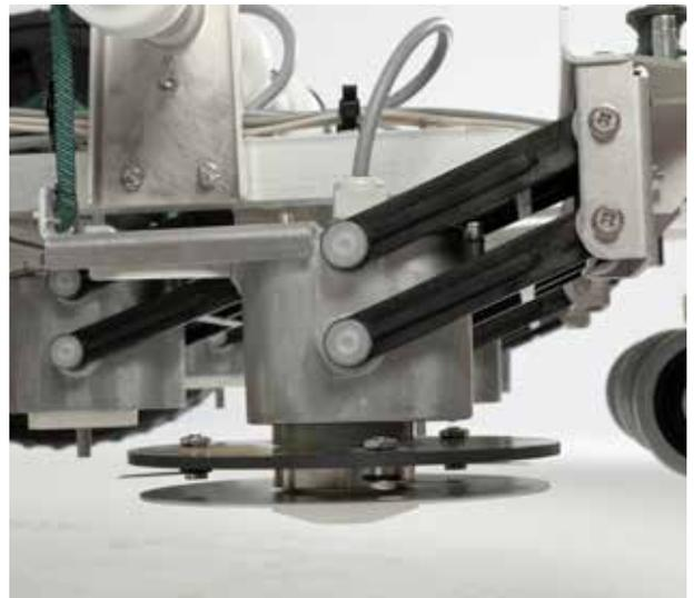
Jeder ECHO Mähroboter besitzt mehrere freischwebende Messerköpfe. Diese passen sich durch eine vertikale Bewegung automatisch der Geländestruktur an.
