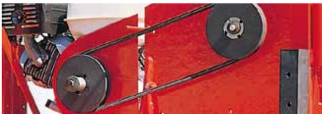
Direkt auf die Antriebsmotoren aufgeflanschte Flügelräder geben die groben Schläge des Materials direkt an die Kurbelwelle weiter. Der Keilriemenantrieb überträgt diese Stöße kaum. Somit ist eine lange Lebensdauer des Motors gewährleistet.
