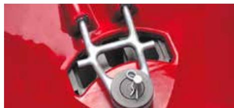
Das komplett neu entwickelte Streusystem des SP-240 besitzt einen oszillierenden Rührfinger. Dieser muss sich nicht drehend durch das Streugut arbeiten, sondern kreist leicht. Ein Verstopfen ist nahezu unmöglich. Der Trichter wird zu 100% entleert.
