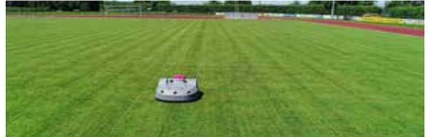
Die Messer des Mähroboters sind so scharf wie ein Skalpell und pulverisieren das Gras in sehr feine Partikel, die als Stickstoffdünger auf dem Rasen verbleiben. Kleinere Mulchpartikel verrotten schneller und verhindern Rasenkrankheiten. Der Rasen wird kräftiger und zeigt ein sattes Grün.
