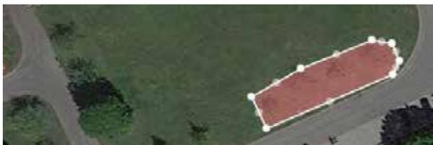
Roboter mit RTK-GPS-Unterstützung erhalten die Möglichkeit hochpräzise GPS-Verbotzonen festzulegen. So können Sie zeitweilig Flächen ausgrenzen um Rasen, der saniert wird zu schonen oder um Blumeninseln ausblühen zu lassen.
