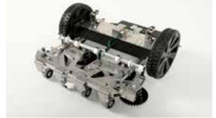
Die robuste Rahmenkonstruktion aus Metall sorgt für lange Haltbarkeit des Roboters. Darüber hinaus sind alle Bauteile gegen das Eindringen von Staub und Wasser geschützt.
