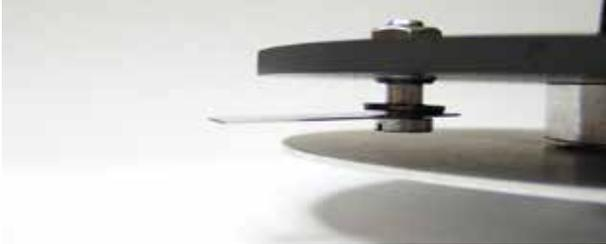
Die Edelmesser sind ultrascharf und gewährleisten somit einen perfekten Schnitt, ohne das Gras zu belasten. Wenn ein Hindernis erkannt wird, können die Messer zurückweichen. Dadurch ist das Verletzungsrisiko von Menschen oder Tieren ausgeschlossen.
