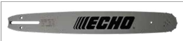
Die laminierten Schienen mit Umlenkstern sind für Motorsägen mit 3/8H und .325 Teilung erhältlich. Die leichte Kurvenform und der kleine Umlenkradius verringern die Rückschlaggefahr und erleichtern die Schnittführung. Die Beschichtung schützt die Schiene vor Kratzern und Korrosion.
