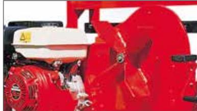
Das besonders robuste und perfekt auf das Gerät abgestimmte Lüfterrad sorgt für eine hervorragende Saugleistung. Optional ist zum Schutz des Gehäuses ein Prallblech erhältlich.
