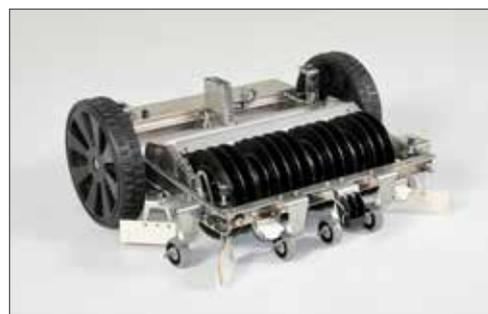
Über rotierende Scheiben werden die Golfbälle aufgesammelt. Die robuste Rahmenkonstruktion aus Metall sorgt für lange Haltbarkeit des Roboters. Darüber hinaus sind alle Bauteile gegen das Eindringen von Staub und Wasser geschützt.
