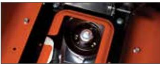
Über den Heckantrieb können die zahlreichen Heckanbaugeräte wie die Rasenpflegemaschine, Anbaustreuer oder Vertikutierer genutzt werden.
