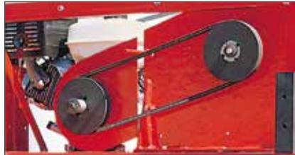
Direkt auf die Antriebsmotoren aufgeflanschte Flügelräder geben die groben Schläge des Materials direkt an die Kurbelwelle weiter. Der Keilriemenantrieb überträgt diese Stöße kaum. Somit ist eine lange Lebensdauer des Motors gewährleistet.
